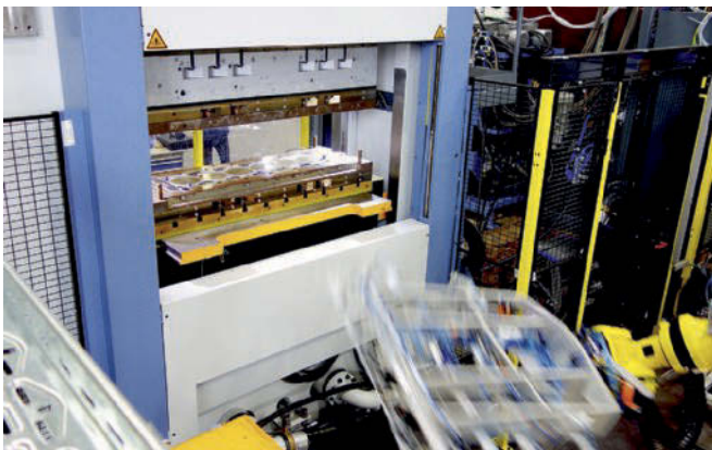
Der Stanzteil der Zylinderkopfdichtung wird mittels Roboter in die Schließereinheit eingelegt, mit Gummi umspritzt und anschließend entnommen. Der Roboter besitzt dafür einen Doppelgreifer.
