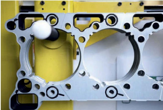
Eine der vier unterschiedlichen Zylinderkopfdichtungen für 5- und 6-Zylinder-LKW-Motoren, mit Abmessungen bis zu 1200 x 250 mm, die auf der Anlage produziert werden.
