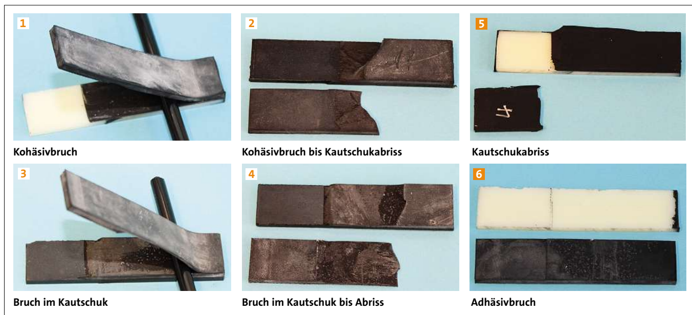
Bruchbilder von Schälproben (Pressplatte) in Anlehnung an DIN 53531: Bilder 1 bis 4 zeigen die angestrebten Bruchbilder im K&K-Verbund, Bilder 5 und 6 zeugen von ungenügender Verbundhaftung.
